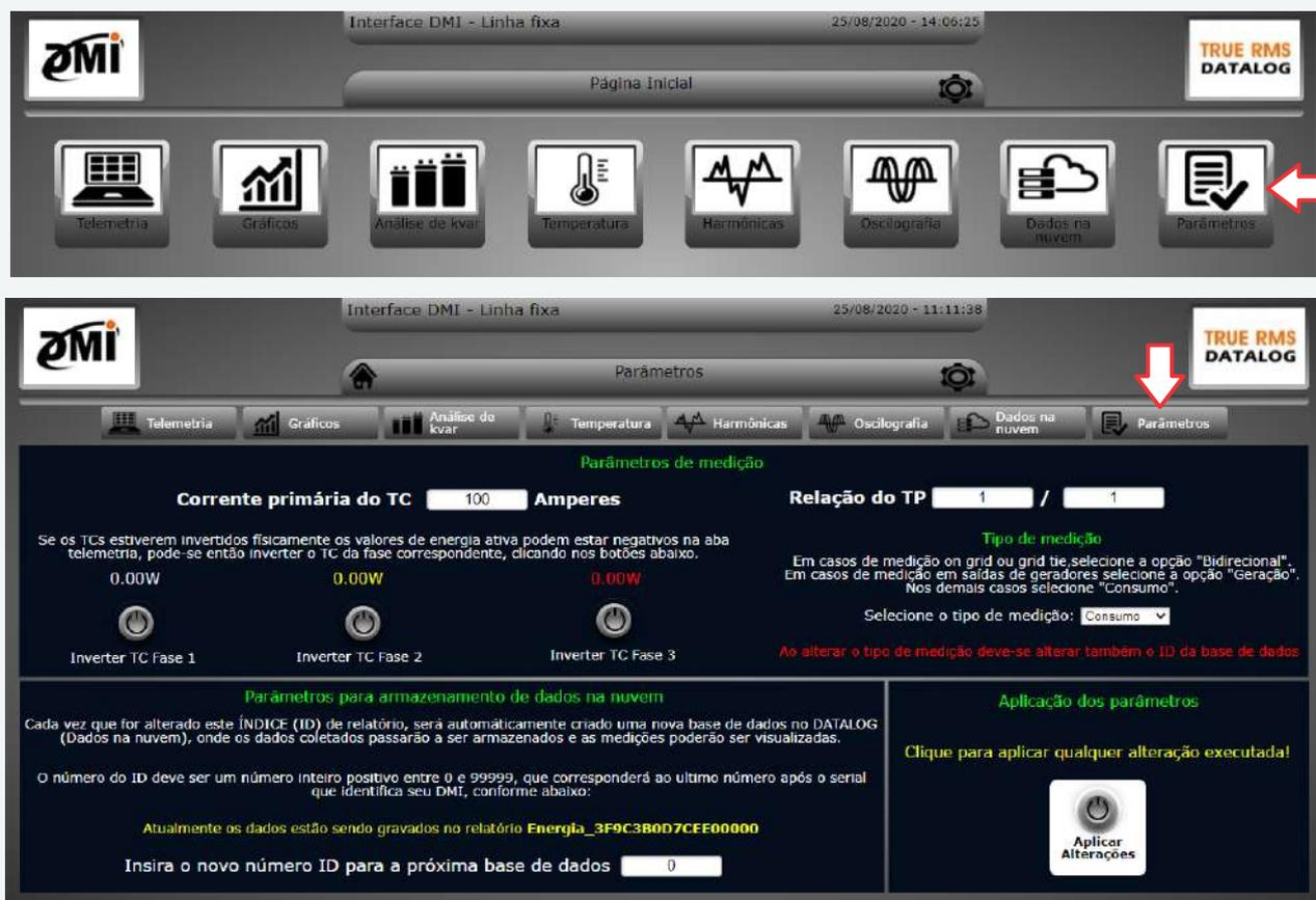
A configuração dos TCs deve estar de acordo com os TCs que estiverem sendo utilizados. Os botões **Inverter TC** servem para inverter virtualmente o sentido do TC, caso a fase correspondente esteja exibindo valores de kWh negativo.
